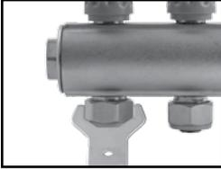
3 - Daha sonra bağlantı borusunun üzerine önceden takılan yüksük ve somun yukarı doğru itilerek kollektör alt nipeline şekildeki anahtar vasıtasıyla sıkarak vidalayın. Bütün kollektör setinin montajı bittikten sonra sistemi TS 9809 standardına uygun 6 bar basınçta su ile 2 dakika boyunca set edin bağlantılarda herhangi bir sızdırma yoksa kollektör seti kullanıma hazırdır.
