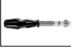
1 - Öncelikle boruyu eksenine dik şekilde kesin. Kollektör alt nipelindeki hareketli somun ve yüksüğü borunun üzerine geçirin, boruları hortum uçlarına takarken o-ringin mevcut kanalından çıkmaması için, şekildeki kılavuz yardımıyla boru ağzlarını mutlaka düzeltin.
