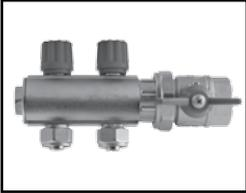
Not : Küresel vana masurasının kollektöre montajında o-ring ile sızdırmazlık sağlanmaktadır. Ayrıca küresel vana gövdesi ile rakor arasında sızdırmazlığı sağlayan özel bir conta mevcuttur. Uygulayıcı isterse küresel vana masurası ile kollektör gövdesindeki bağlantısındaki dişlerde ayrıca sıvı conta kullanabilir. Teflon ve keten kullanımı söz konusu olduğunda, aşırı kullanımdan kaçınılmalıdır.
