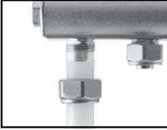
2 - Bağlantı borusu hortum ucuna takıldığında, o-ringin mutlaka borunun altında pozisyonunun bozulmayacak şekilde kalması sağlanmalı ve borunun hortum ucunun sonuna kadar oturduğu mutlaka kontrol edilmelidir.
